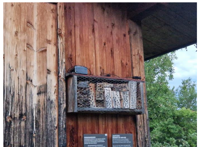
Deponierter stationärer Fledermausdetektor, welcher die Fledermausrufe der gesamten Nacht aufgezeichnet und abgespeichert hat (Foto: Pascale Hutter).
